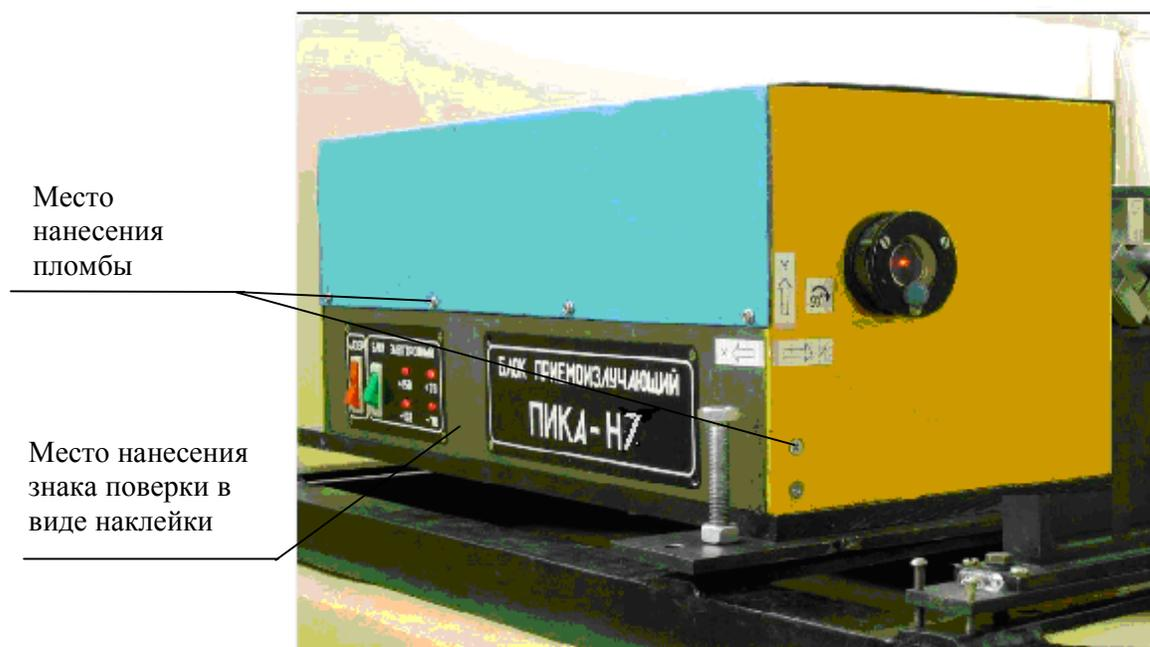
Рисунок 2 – Приемоизлучающий блок
