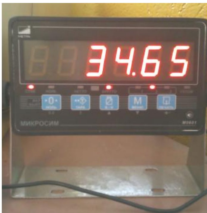
Рисунок 2 – Внешний вид прибора весоизмерительного Микросим-06
