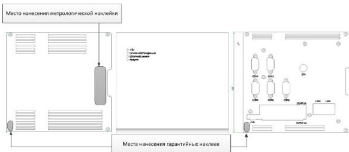
Рисунок 2 – Общий вид и места пломбирования контроллера ARIS MT200
