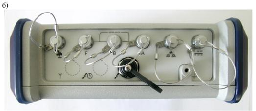
Пломбирование крепёжных винтов корпуса аппаратуры геодезической спутниковой Spectra Precision ProFlex800 не производится, все внутренние крепежные винты залиты пломбирующим лаком.
