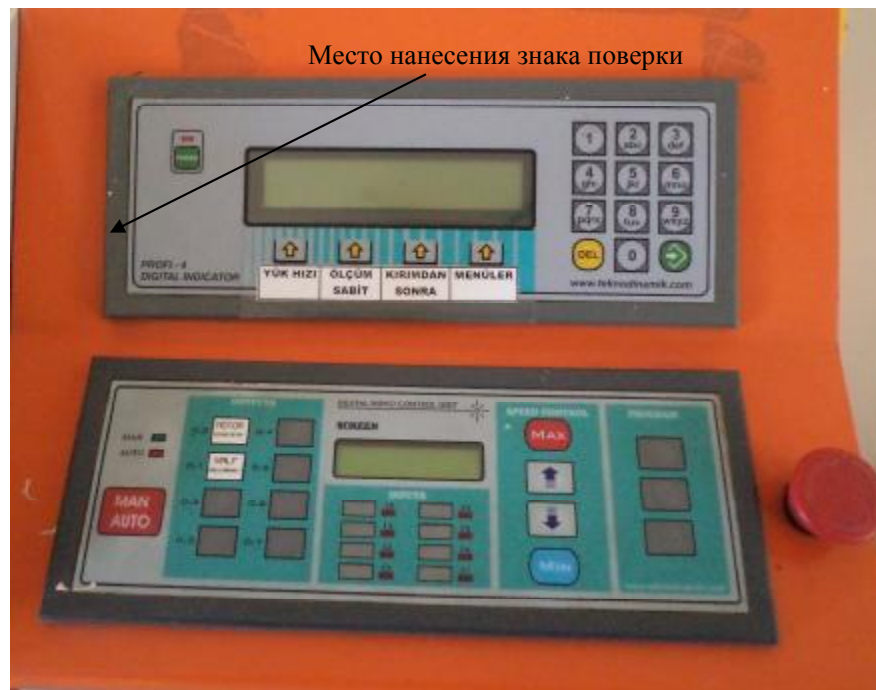
Рисунок 2 – Схема пломбировки прессы от несанкционированного доступа
