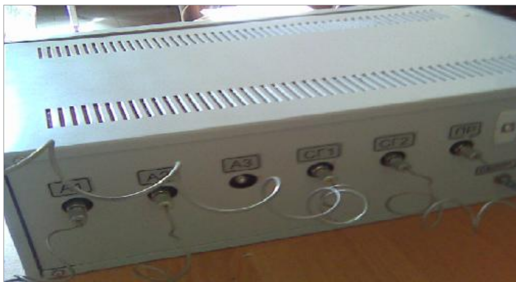
Рисунок 2 – газоанализатор кислорода «Оксид-01», вид задней панели.
