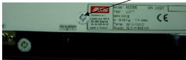
Рисунок 1 - Схема пломбирования весов от несанкционированного доступа
