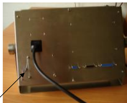
Рис.3 Внешний вид и схема пломбирования индикатора ЭТА-01
