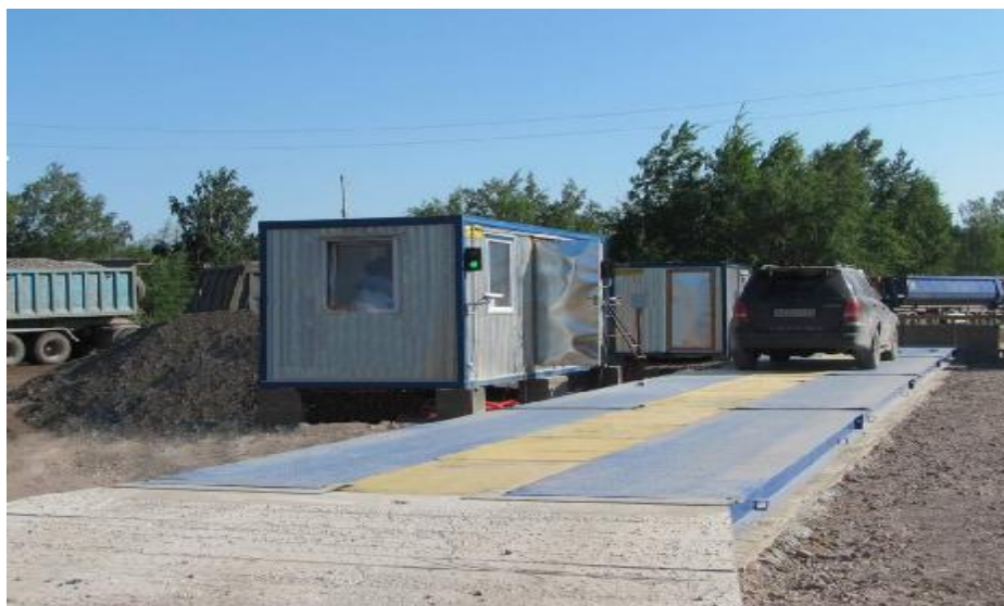
Рис. 1. Общий вид весов Магнус 60-24. Установка на железобетонный фундамент.
