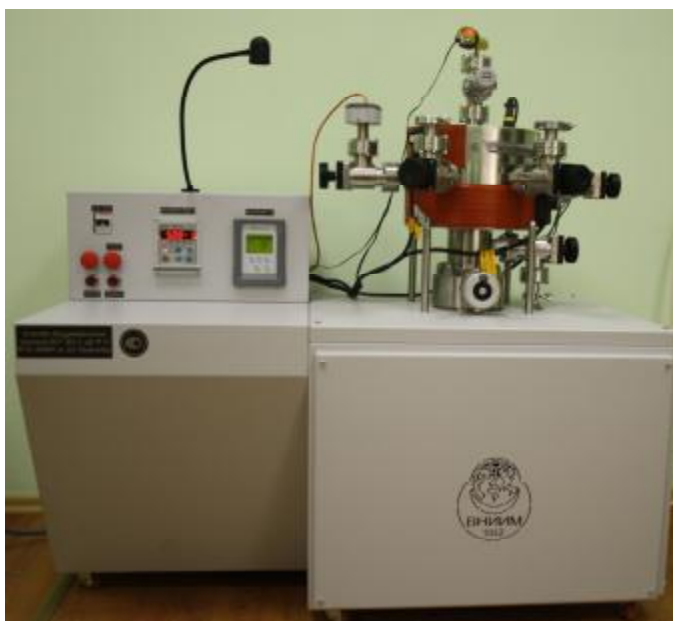
Рисунок 1 – Установка вакуумметрическая эталонная 2-го разряда ВАТТ УВЭ-3
