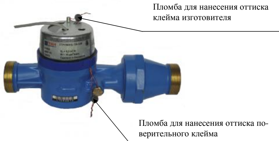
Рисунок 2 – Места клеймения и пломбирования счетчиков СВ-32 "СТРУМЕНЬ", СВ-40 "СТРУМЕНЬ"
