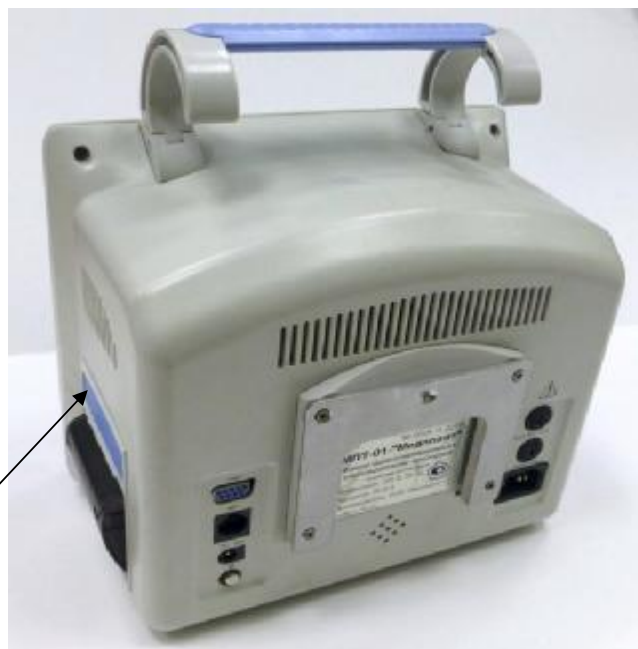
Рисунок 2 – Схема маркировки и пломбировки от несанкционированного доступа.
