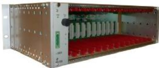
Рисунок 1 - Общий вид контроллера ARIS C303 сзади (модули не установлены)
