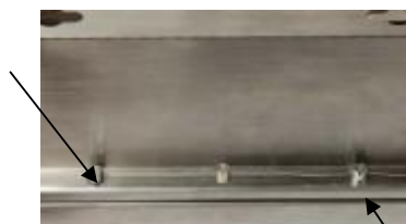
Рисунок 3 - Пример пломбировки корпуса терминалов
