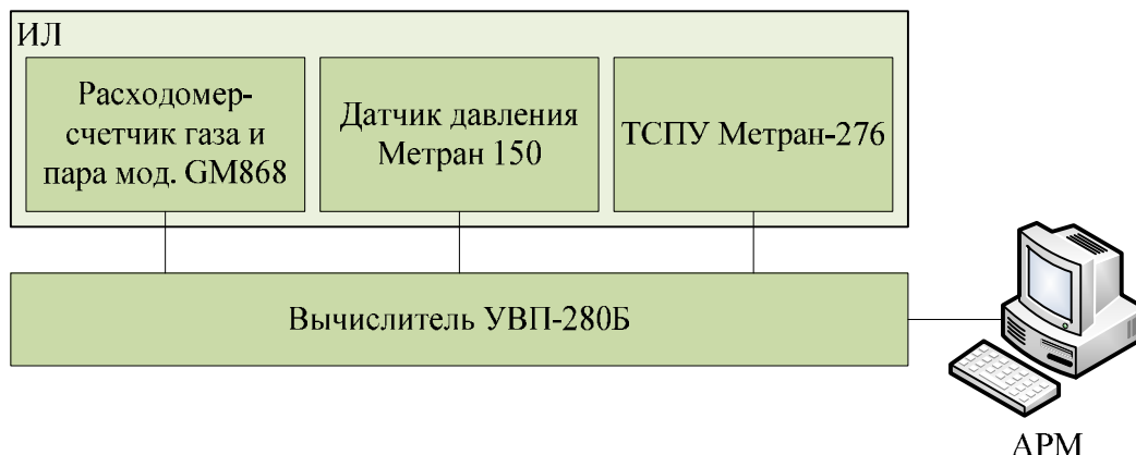
Рисунок 1 – Структурная схема СИКГ
