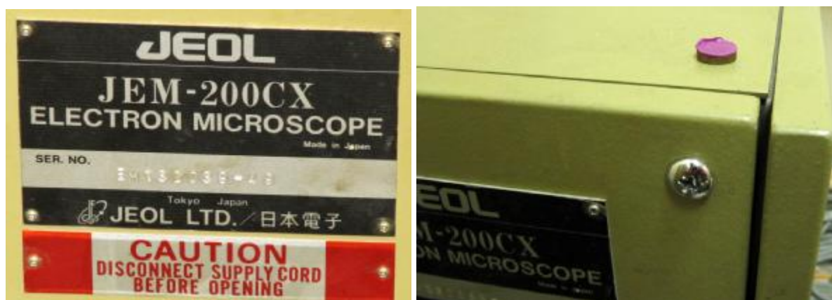
Рисунок 2 – маркировка и пломбирование микроскопа электронного просвечивающего JEM 200CX
