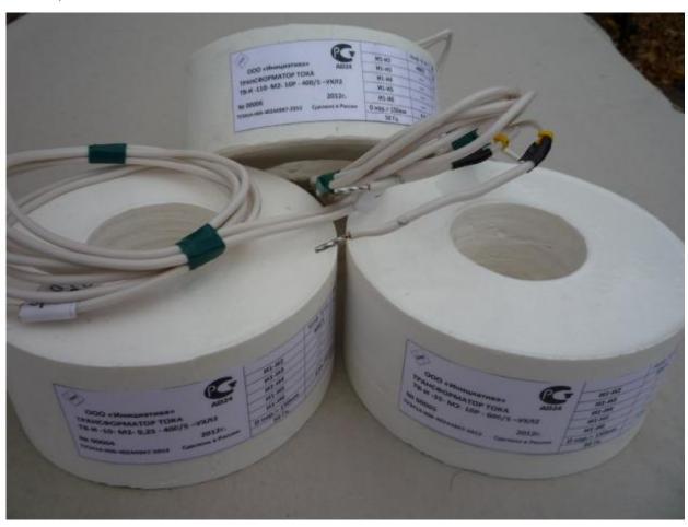
По принципу конструкции трансформаторы являются встроенными, т.е. без собственной первичной обмотки и ее изоляции. Трансформаторы устанавливаются непосредственно на изолированные ввод или провод, которые являются первичной обмоткой.
