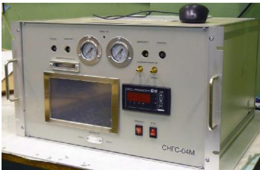
а) газоаналитический блок
