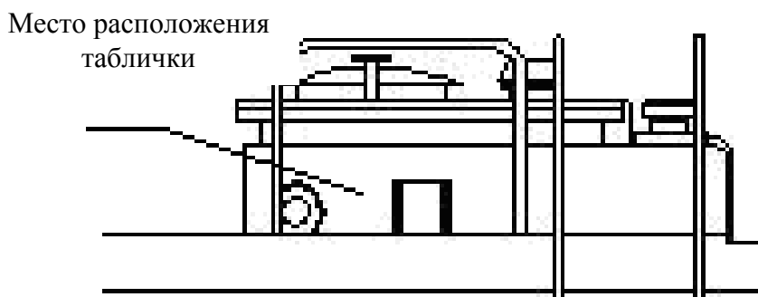
Рисунок 1. Обозначение места для нанесения оттиска поверительного клейма.
