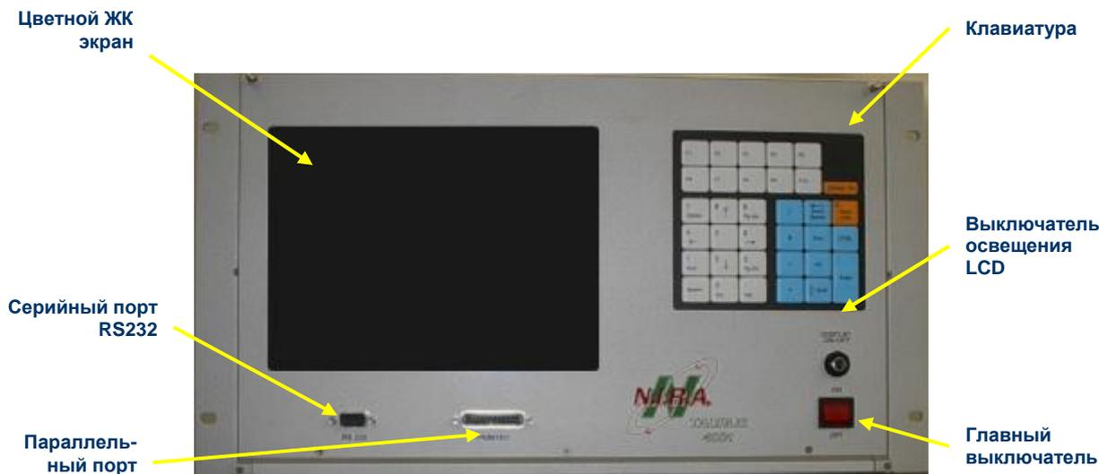
Рис.1. Фотография блока управления анализатора Taurus 4001.
