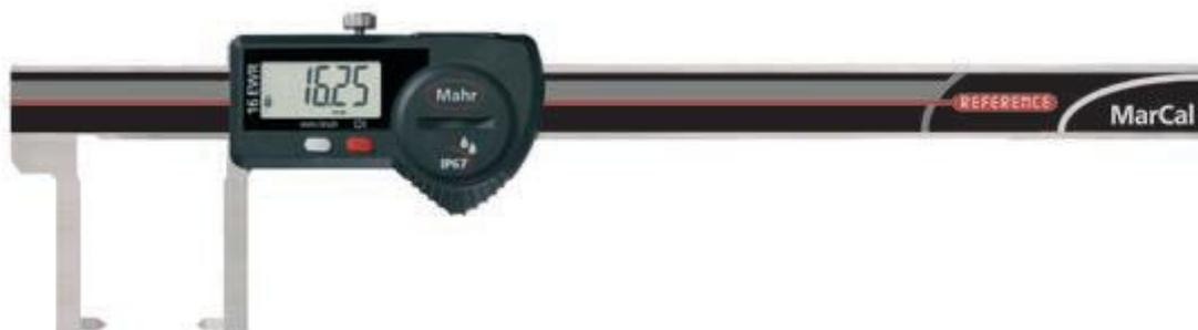
Рисунок 9 – Штангенциркуль MarCal 16 EWR-SA
