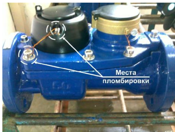
Рисунок 1.8 – схема пломбировки (на примере счетчика серии Dual)
