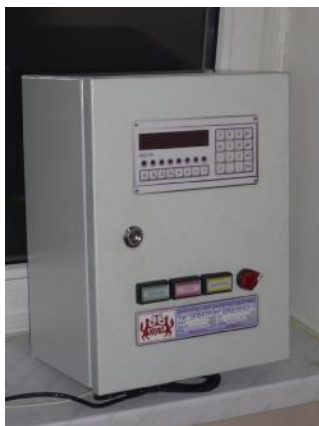
Рисунок 4- Внешний вид контроллера весового КВД-004
