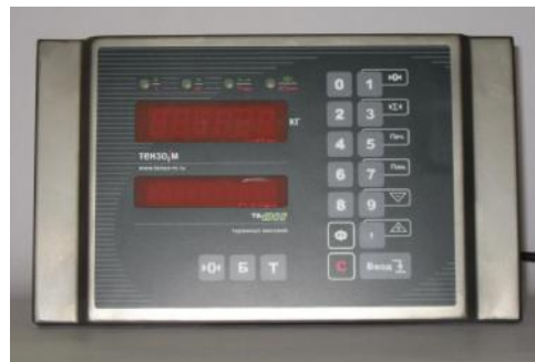
Рисунок 5 – Внешний вид весоизмерительного преобразователя ТВ
