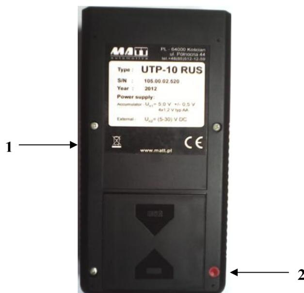
Рис.2 Места нанесения знака утверждения типа (1) и пломбирования (2).
