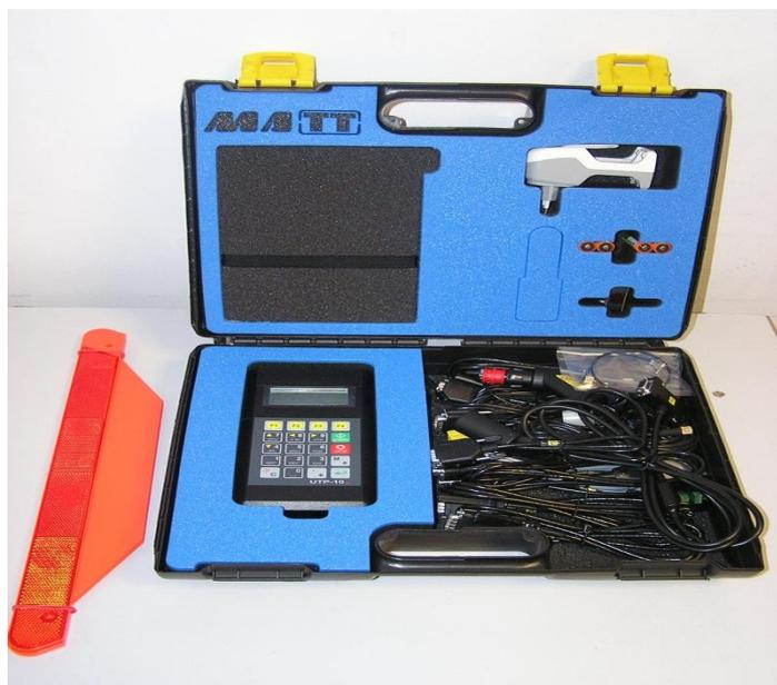
Рис.1 Общий вид прибора для поверки тахографов UTP-10 RUS с комплектом поставки.
