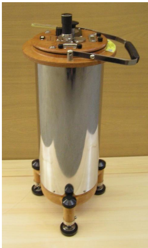
Рисунок 1. Общий вид гравиметра наземного узкодиапазонного с кварцевой чувствительной системой класса В ГНУ-КВ.
