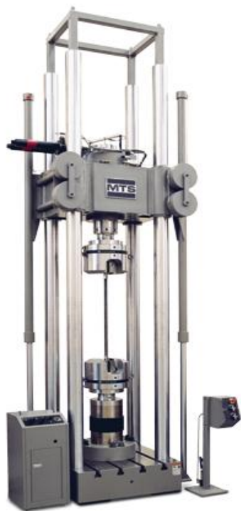
Рисунок 2. Общий вид машины испытательной сервогидравлической MTS с силовой рамой 311 с четырьмя колоннами.
