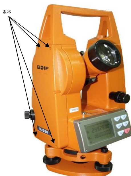
Примечание ** - места пломбирования от несанкционированного доступа Рисунок 3 - Схема пломбировки от несанкционированного доступа
