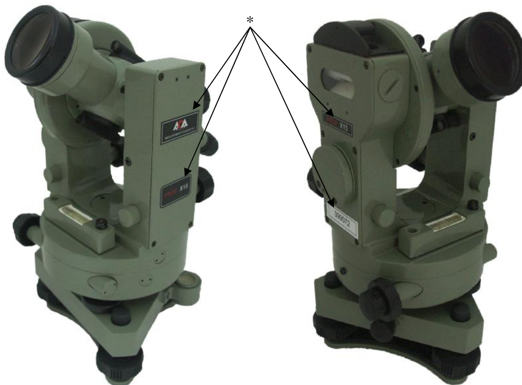
Примечание * - обозначения мест для размещения наклеек Рисунок 1 - Внешний вид теодолита и схема размещения наклеек
