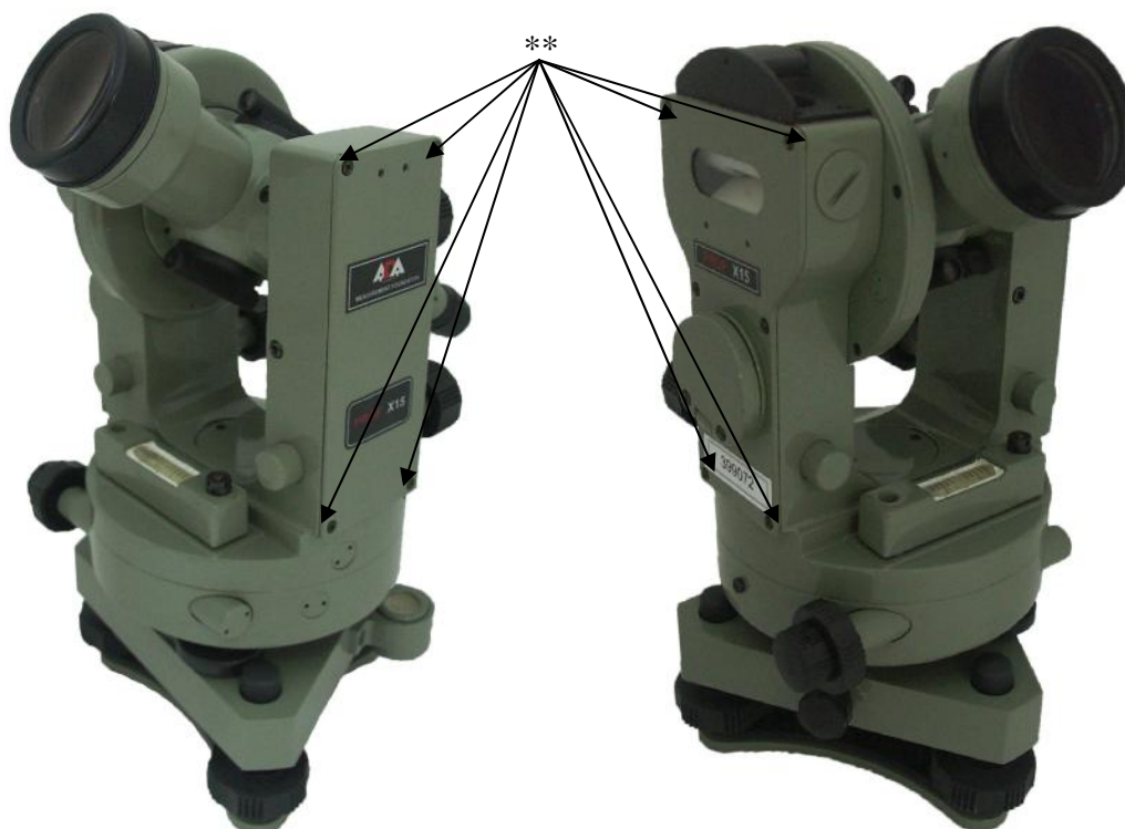
Примечание ** - места пломбирования от несанкционированного доступа Рисунок 3 - Схема пломбировки от несанкционированного доступа
