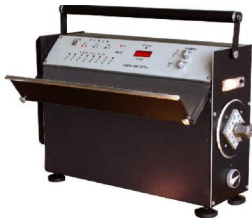
Рисунок 1 - Виброустановка поверочная переносная ВСП-02
