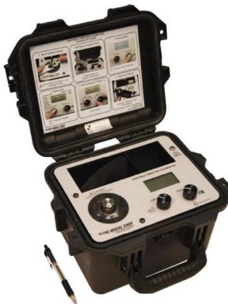
Рисунок 1 - Виброустановка калибровочная портативная
