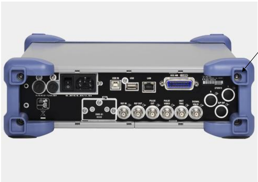
Рисунок 2 - Схема пломбировки от несанкционированного доступа
