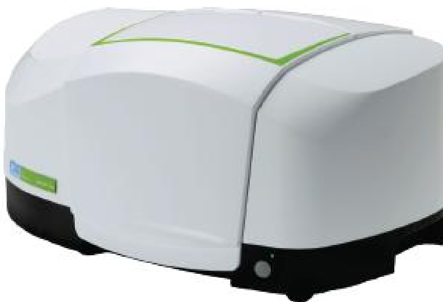
Рисунок 1 - Общий вид Фурье-спектрометра инфракрасного Spectrum Two DTGS
