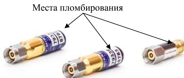
Рисунок 2 – Места пломбирования нагрузок и аттенюаторов (наклейки)
