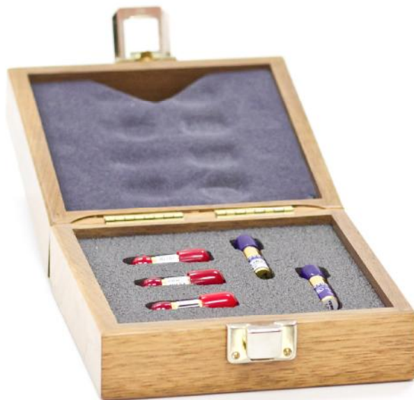
Рисунок 1 – Внешний вид набора мер коэффициентов передачи и отражения Н/М-50-2,4 мм
