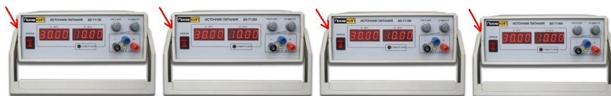
Рисунок 2 – Схема пломбировки от несанкционированного доступа.
