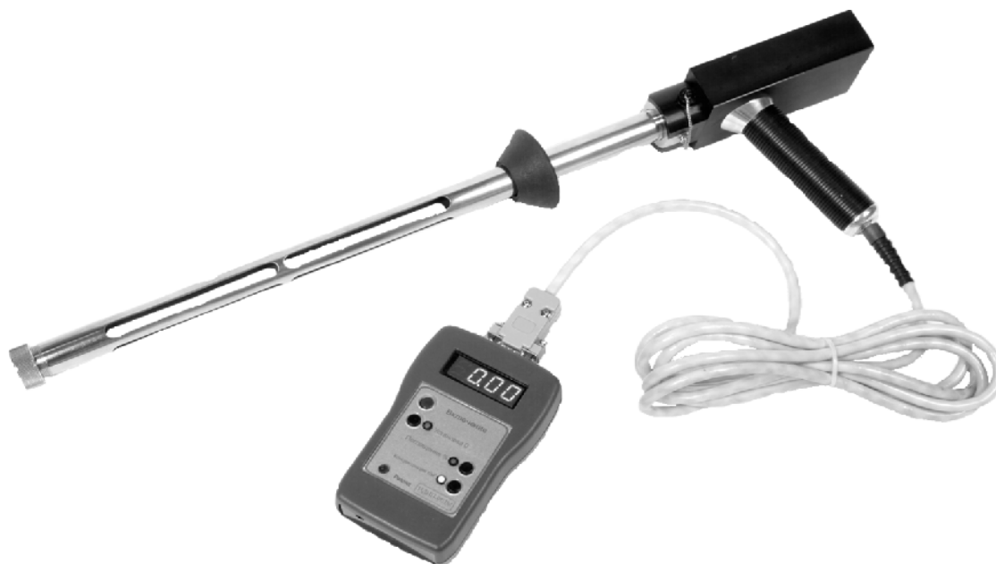
Рис. 1. Внешний вид измерителей пыли «ИДИП-01ПМ»
