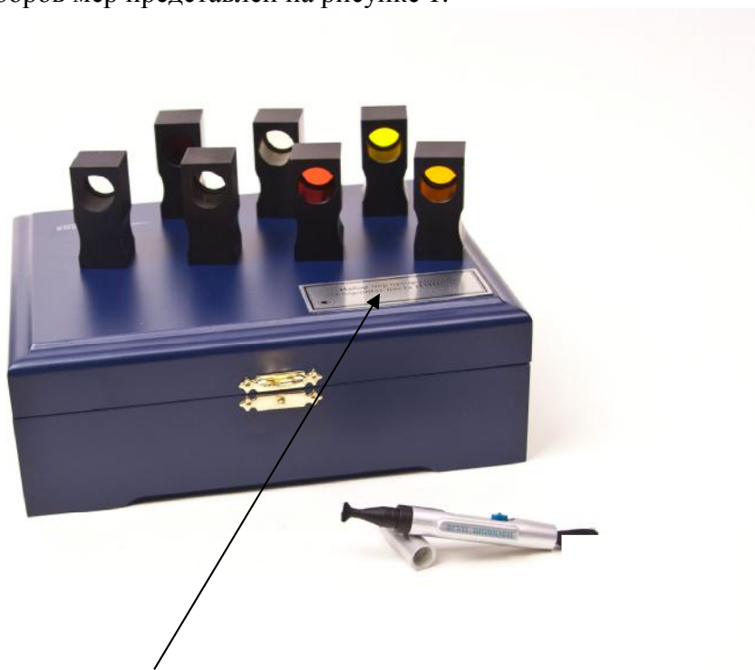
Рисунок 1 – Внешний (общий) вид наборов мер НМП моделей НМП-01 и НМП-02 ,
