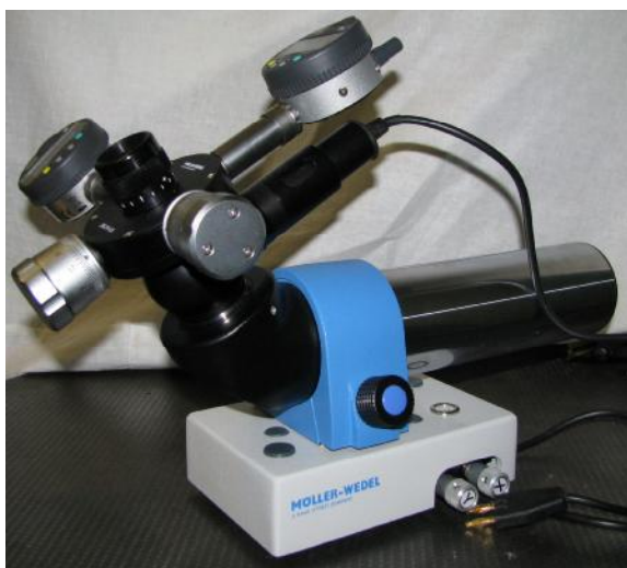
Рисунок 1 – Внешний вид автоколлиматора
