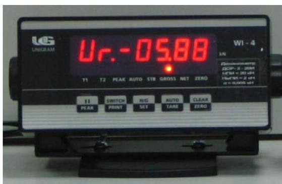
Рисунок 1. Внешний вид электронного блока с изображением версии программного обеспечения.
