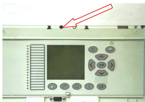
Рисунок 3 - Схема пломбирования блоков контроллеров MiCOM C264
