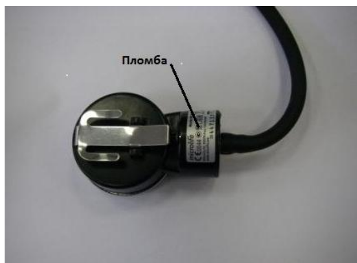
Рис.2 Фотография места пломбирования манометра средства измерений
