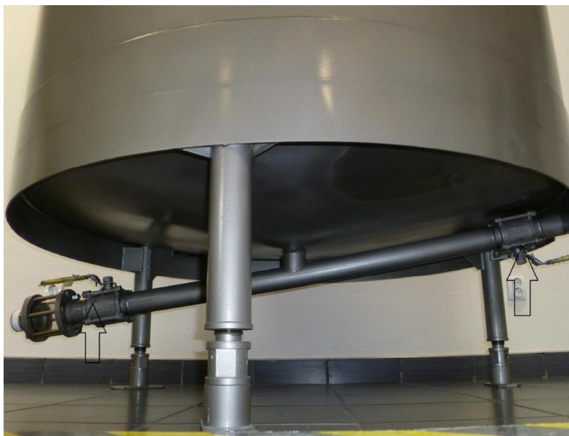
Рисунок 2-3 Места пломбировки от несанкционированного доступа
