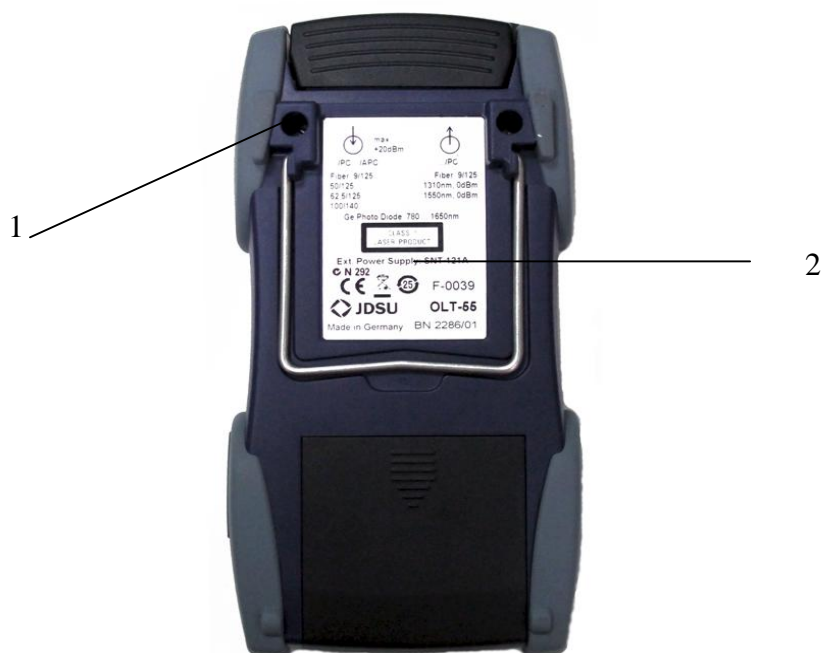
Рисунок 2 - Схема пломбирования и маркировки тестера – вид сзади 1 - место установки пломбы; 2 - место нанесения маркировки
