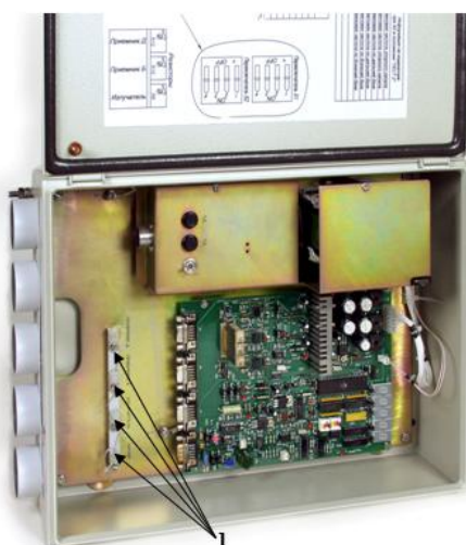
Рисунок 1. Измерители ИМДВ-01. Приемник - 1, излучатель - 2, блок электроники - 3, блок сопряжения – 4, блок управления и индикации – 5.
