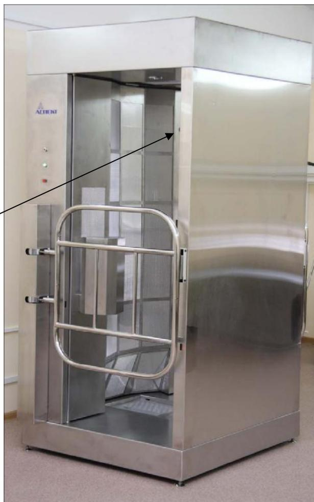
Рисунок 1 - Общий вид установки контроля радиоактивного загрязнения персонала атомных станций «РЗС-02А»
