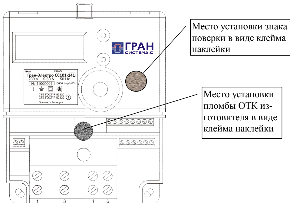
Рисунок 5 – Места установки знака поверки и пломбы ОТК изготовителя на счетчик модификации «Гран-Электро СС-101-XXXXS» (вид со снятой крышкой зажимов)
