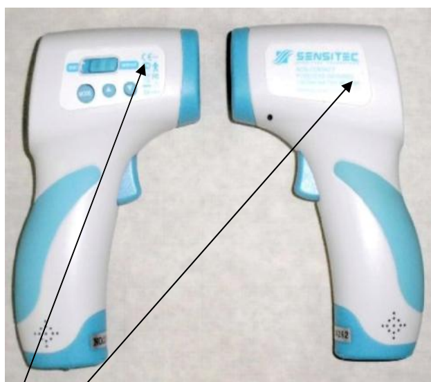
Место нанесения знака утверждения типа Место пломбировки от несанкционированного доступа Рисунок 1 – Модель SENSITEC NF-3101
