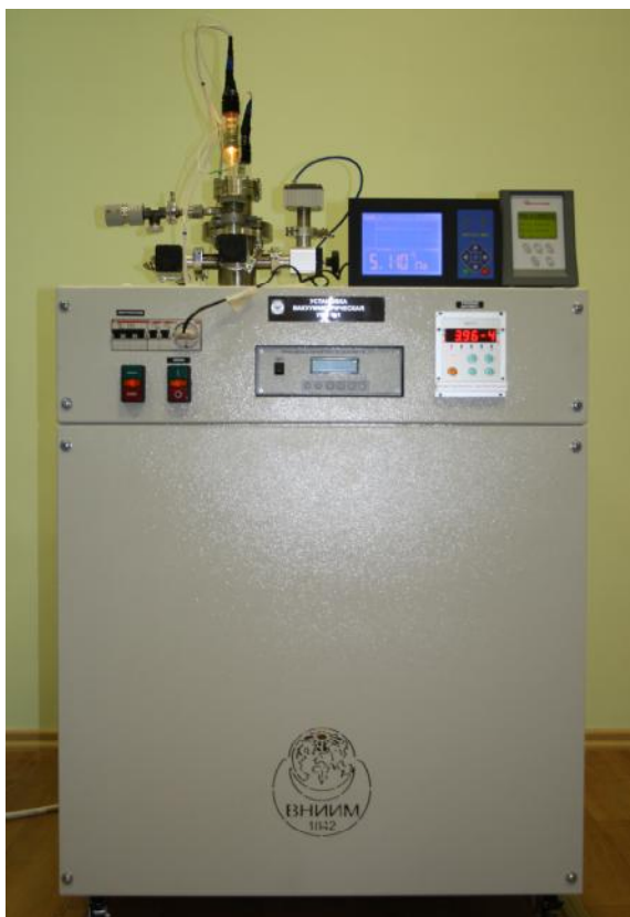
Рисунок 1 – Установка вакуумметрическая эталонная 2-го разряда УВО
