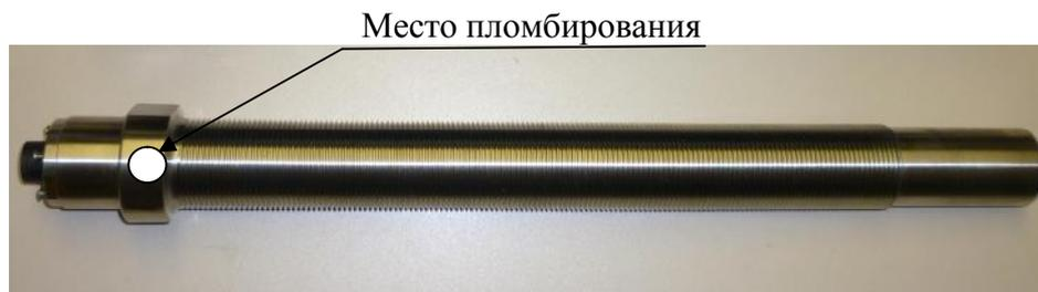
Фото 1 - Общий вид датчика и места пломбировки
