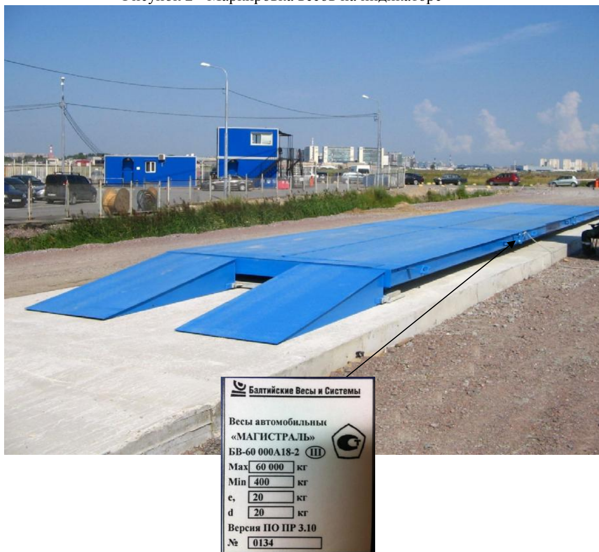
Рисунок 3 - Маркировки весов на грузоприемном устройстве
