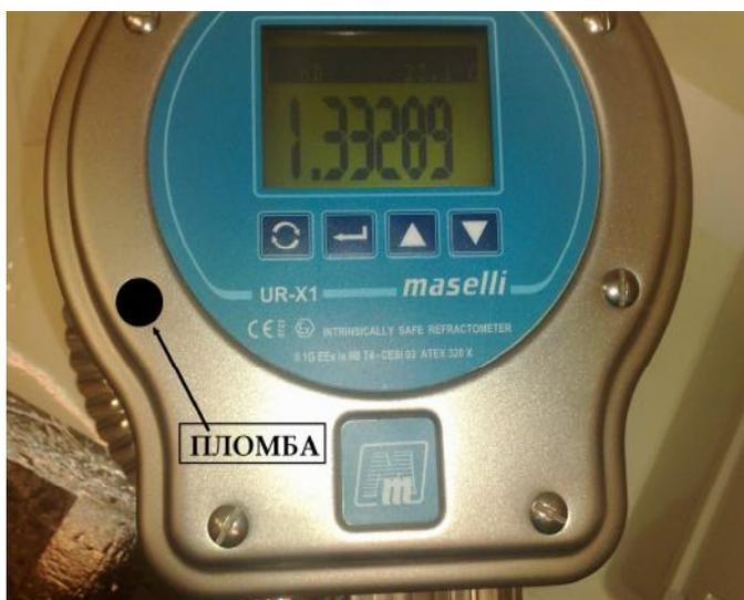
Рис. 1. Рефрактометр промышленный цифровой UR-X1, зав. № P0650.
